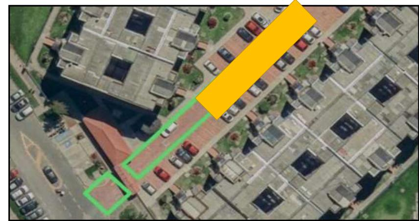
**ZONA 1 - 2: SE DIVIDIRÁ EL PRIMER TRAMO (ZONA 1) EN 2 TRAMOS; EL SEGUNDO IRÁ DESDE EL KM 0+024 HASTA KM 0+048, POR EL TOTAL DEL ANCHO DE LA VÍA.**
